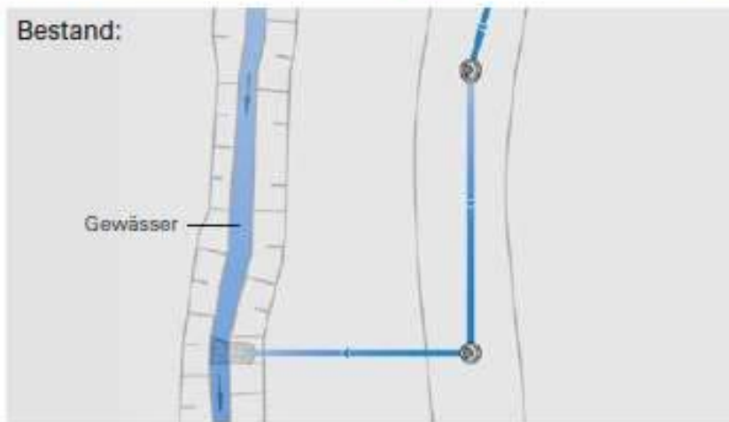
vorhandener Regenwasser-Kanal ohne Vorreinigung
