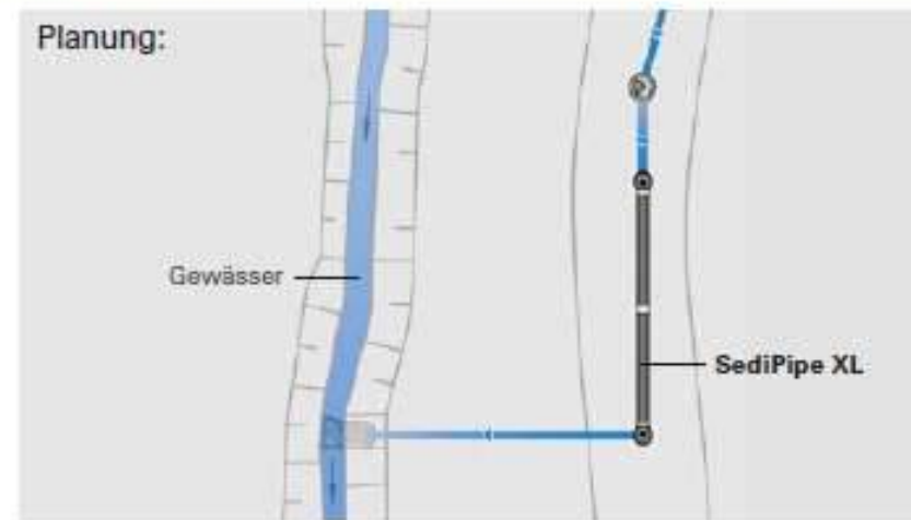
vorhandener Regenwasser-Kanal mit SediPipe-Vorreinigung
